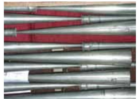
De door loodwit uitgezette koppen van de Trompet 16 vt van het hoofdmanuaal in 2003.
