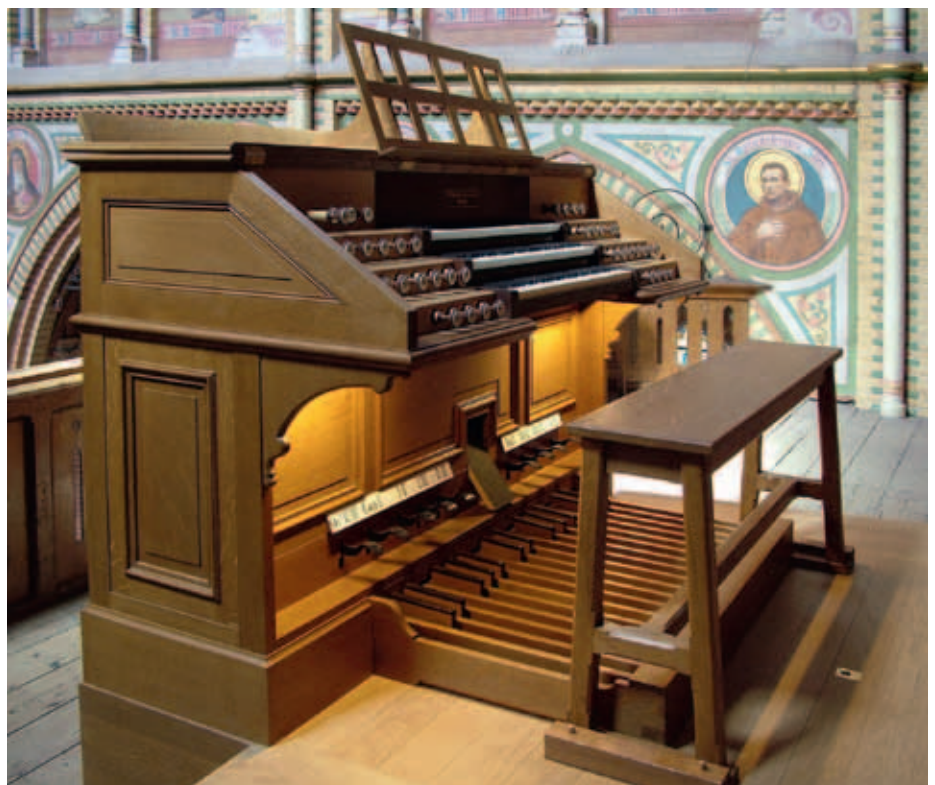
De naar voorbeeld van het Concertgebouw in Amsterdam gereconstrueerde speeltafel, met links de treden van de nieuwe suboctaafkoppel, de combinatielade en de manuaalkoppels; rechts de pedaalkoppels en de tremulant.
