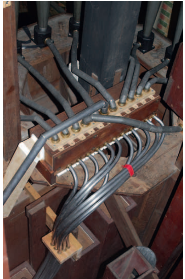
De in oorspronkelijke staat teruggebrachte moteurs pneumatiques in de pedaaltoeren aan de C-zijde van de kast; deze voeden de grootste pijpen van de Prestant 16 vt.
