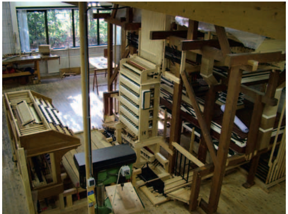
Opstelling van het binnenwerk en de nieuwe speeltafel in de werkplaats van Elbertse in Soest. Duidelijk zichtbaar zijn de registertractuur naar het pedaal (rechts) en de speeltractuur via de Barker-machine naar het hoofdmanuaal (boven) alsmede positief en récit (buiten beeld).
