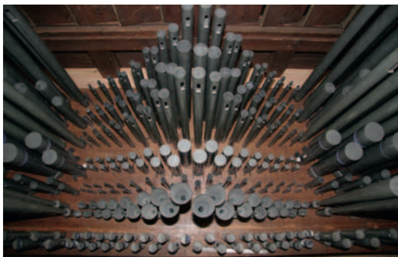
De lade van het Récit. Van boven naar onder VdG 8, Fo 4, Vc 8, Hp 8, Pi 2, BH 8, VH 8; boven nog een stukje van de lamellen, waarvoor zich het positief bevindt. Opvallend is de grote ruimte tussen beide tongwerken. Op de stok is een moet zichtbaar; zou hier ooit een klankkastje hebben gestaan?
