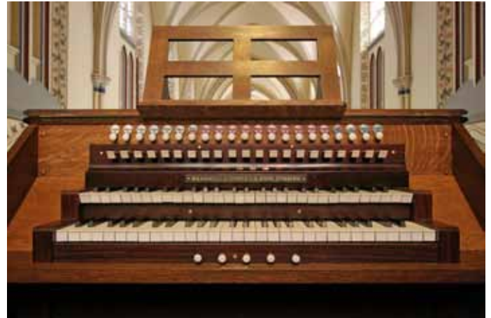
De speeltafel van Weigle met inhaaktoetsen voor de registers, de vrije combinatie en vier vaste combinaties.
