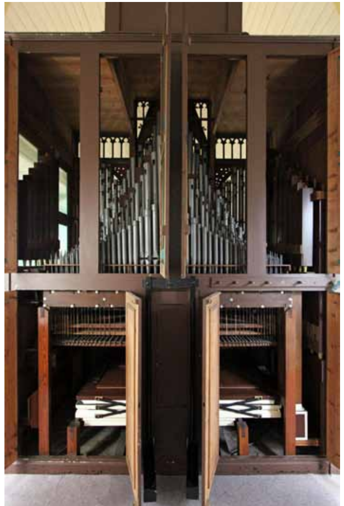
Achteraanzicht van de ruime kast waarin al het pijpwerk onverkropt kan staan; onderin de gerestaureerde windvoorziening.
