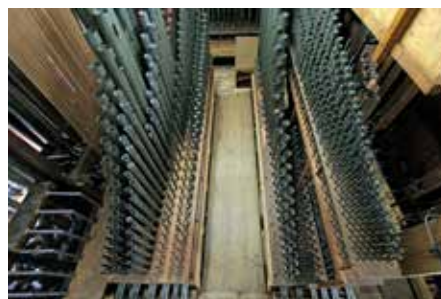
Beide chromatische hoofdwerkkladen na de restauratie; links de gereconstrueerde conducten naar de frontpijpen en de speeltractuur naar het bovenwerk, rechts de Prestant 16 vt van het pedaal
